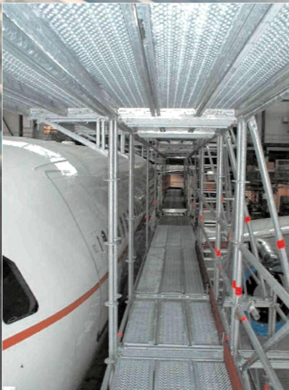
Фюзеляжный док представляет собой жесткую конструкцию, которая позволяет проводить работы по обслуживанию фюзеляжа самолета на различных уровнях высоты с максимальной безопасностью. Для безопасного проведения работ предусмотрены специальные лестничные марши и перила безопасности.
