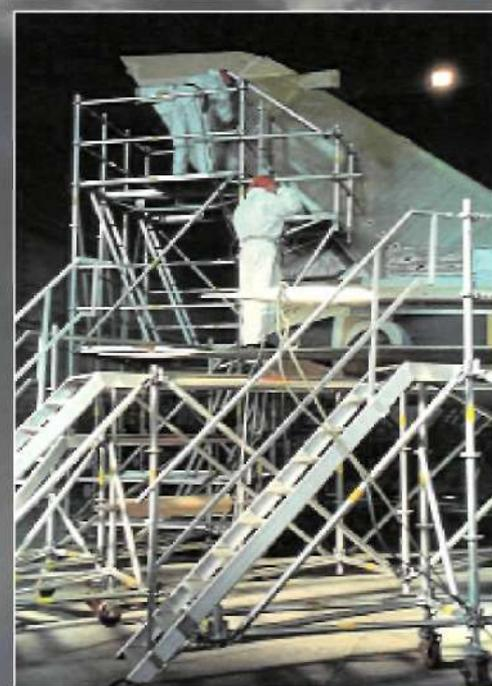
Хвостовой док представляет собой жёсткую конструкцию, которая позволяет проводить работы по ремонту, покраске и техническому обслуживанию хвостовой части воздушного судна на различных уровнях высоты с максимальной безопасностью. Док может состоять из 2 или 4 частей, что позволяет удобно хранить его и быстро вводить в эксплуатацию. Для перемещения частей дока, в конструкциях используются специальные колёса с двойными тормозами.
