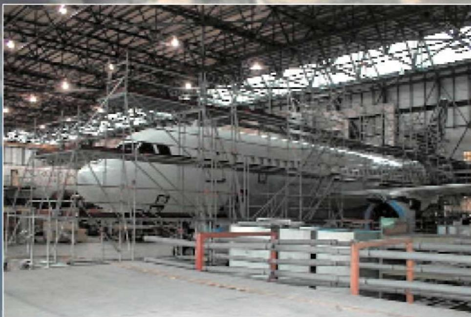
Фюзеляжный док может применяться как стыковочный модульный элемент между носовым, крыльевым и хвостовым доком, для обеспечения более удобного доступа к воздушному судну.
