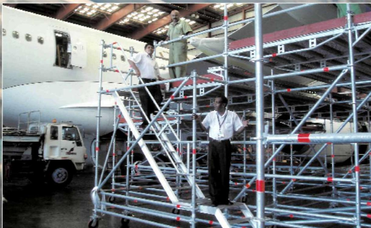
Служит для обеспечения доступа к закрылкам и топливным системам самолёта. В зависимости от целей и задач по техническому обслуживанию и ремонту, крыльевой док разрабатывается в различных конфигурациях: Ступенчатый крыльевой док – состоящий из нескольких частей стыкующихся между собой с учётом геометрии крыла. Наклонный крыльевой док – с плавными переходами по высоте рабочего настила с учётом геометрии крыла.
