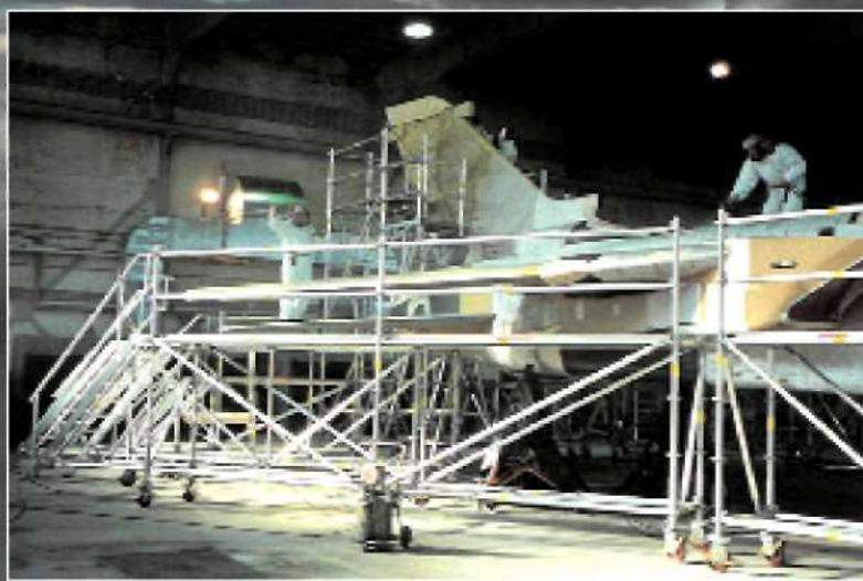
С учетом быстрого монтажа металлоконструкций доковых систем и обеспечения доступа к фюзеляжу самолета, покрасочные работы можно проводить максимально быстро, в том числе:
